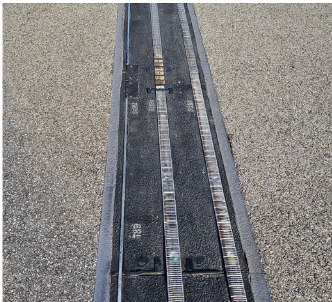
Rail à deux conducteurs dans la solution Alstom expérimentée en fin d'année 2025 sur le site de Transpolis. © Équilibre des Énergies.
