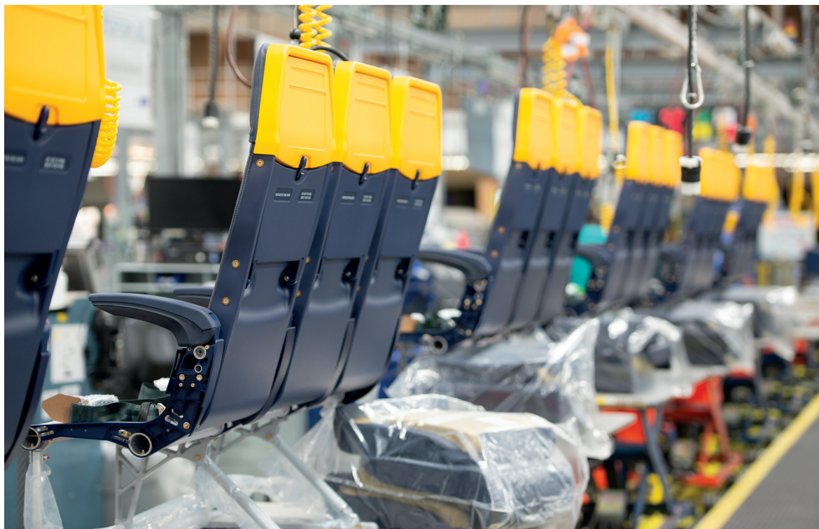
Assemblage final de sièges de classe économique. © Frank Rogozinski/CAPA Pictures/Safran.
